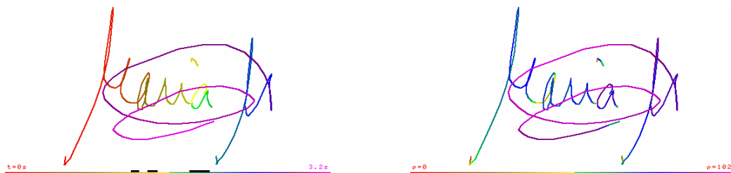
On-line sinadura beraren ibilbidea eta iraupena ezkerrean, eta presioa eskuinean.
